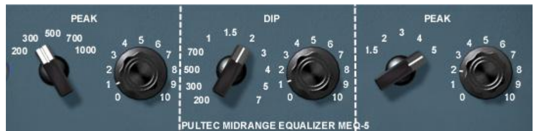
Bild 23. Gruppierung der Regler im Pultec MEQ-5
