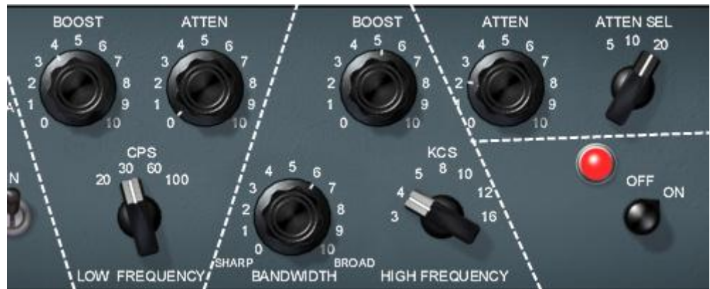
Bild 21. Die Gruppierung der Regler im Pultec EQP-1A
