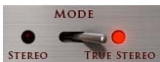
Die Mode-Anzeige zeigt an, ob das Preset ein Stereo oder ein True Stereo Preset ist. Es ist kein Schalter und dient nur der Anzeige und kann nicht verändert werden.
