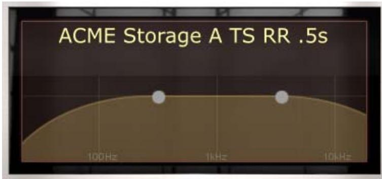
Wenn der Display-Knopf gedrückt ist, werden die Hoch- und Tiefpassfilter angezeigt. Durch Klicken mit der Maus auf einen der beiden Punkte (links der Hochpassfilter, rechts der Tiefpassfilter) und bei gedrückter Maustaste können die Filter durch ein Bewegen nach links oder rechts eingestellt werden.
