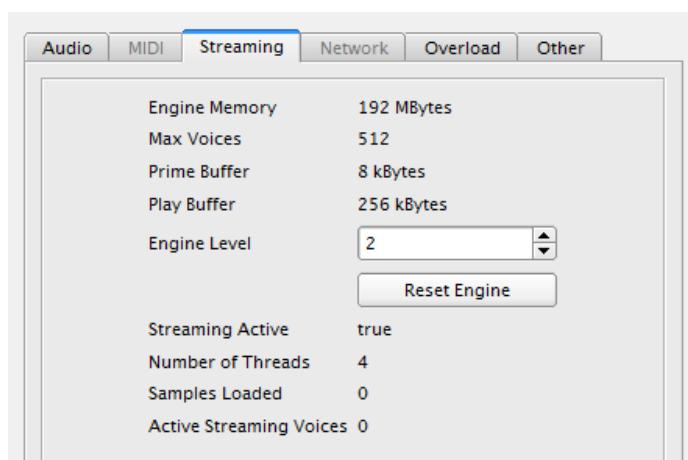
Ändern des Engine-Levels-Reglers von 0 bis 5 stellt sechs verschiedene standardisierte Einstellungen, wie viele Puffer im RAM angelegt werden sollen und wie groß diese sind, zur Verfügung. Wie im Bild oben zu sehen ist, beeinflusst der Engine-Level mehrere Parameter: den Speicherplatz für die Engine, die Anzahl der maximal gleichzeitige spielbaren Stimmen, und die Größe des primären und des abspielenden Puffers.
