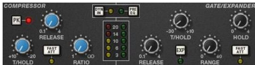
**Noise Gate/Expander:** Um das Noise Gate/Expander einzuschalten, drehen Sie den Range-Regler soweit auf, dass er nicht mehr auf null steht. Die grüne Anzeige auf der rechten Seite der beiden Pegelanzeigen in der Mitte des Dynamikbereiches zeigt den Wert der Pegelreduzierung an.
