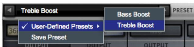
In der unteren linken Ecke des Drawers eines Plug-Ins befindet sich eine Dropdown-Liste mit dem Namen Preset. Nachdem Sie die Werte der Regler in einer Konfiguration eingestellt haben und sie später wiederverwenden möchten, können Sie auf das Dropdown-Menü klicken und Save Preset auswählen. Geben Sie dem Preset dann einen Namen. Später, wenn Sie alle Einstellungen der Regler aus der gespeicherten Konfiguration heraus übernehmen möchten, dann wählen Sie den Preset-Namen aus dem Dropdown-Menü aus.
