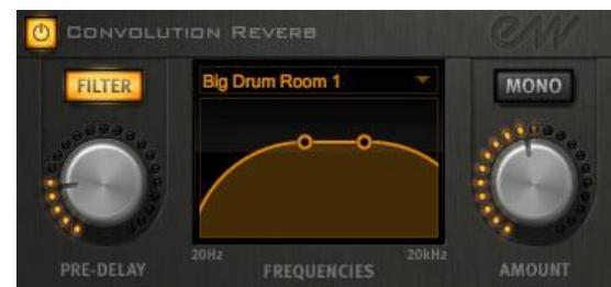
Schalten Sie den **Filter** des Faltungshalls durch einen Klick auf den Filter-Knopf ein, so dass er leuchtet. Dann benutzen Sie die beiden runden Kreise in der grafischen Darstellung der Kurve, um die Frequenzen, die der Filter beeinflussen soll, einzustellen. Verschieben Sie die Kreise mit der Maus (oder mit einem Stift oder den Fingern, wenn Sie einen Touchscreen haben).
