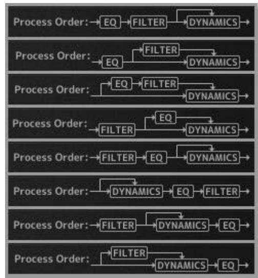
Um den Filterbereich nach dem EQ zu platzieren, deaktivieren Sie den Eingangs-Regler im Filterbereich, so dass das Licht aus ist.
