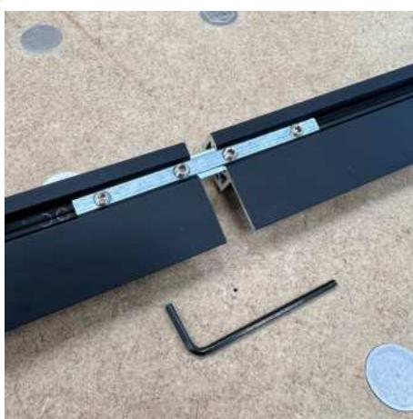
UM DEN ANSCHLAG ZU VERLÄNGERN, BENÖTIGEN SIE DEN VERBINDE. UM DIE BEIDEN HÄLFTEN MITEINANDER ZU VERBINDET. BEGINNEN SIE DAMIT, DASS DER FLACHE TEIL DES ANSCHLAGS ZU IHNEN ZEIGT. STECKEN SIE DEN VERBINDE IN EINE SEITE DES ANSCHLAGS UND DANN IN DIE ANDERE SEITE. DRÜCKEN SIE DIE BEIDEN HÄLFTEN ZUSAMMEN, BIS SIE SICH TREFFEN. ZIEHEN SIE DANN DIE MADENSCHRAUBEN MIT EINEM 2,5-MM-INBUSSCHLÜSSEL FEST.
