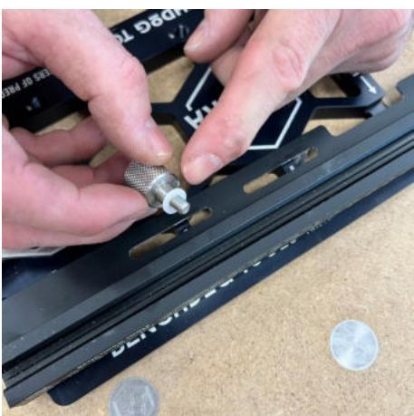
NEHMEN SIE DIE MITGELIEFERTE RÄNDLERSCHRAUBEN MIT DEN KUNSTSTOFFUNTERLEGSCHIEBEN.
