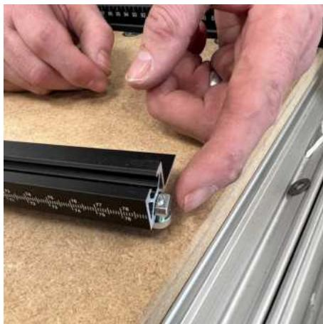
SCHIEBEN SIE DANN DIE KALIBRIER-SCHRAUBE MIT DER ANGEBRACHTE MUTTER IN DEN REPEAT STOP AN DER UNTERSEITE.
