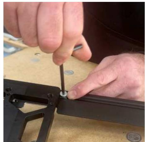
SCHIEBEN SIE DIESE BIS ZUM SCHIENENVIERKANT UND ZIEHEN SIE SIE MIT DEM 3MM-INBUSSCHLÜSSEL FEST UND SCHON IST SIE KALIBRIERT.
