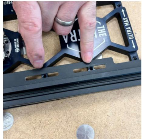
RICHTEN SIE DIE SCHLITZE DES REPEAT STOPS AN DEN RS LÖCHERN AUF DEM RAIL SQUARE
