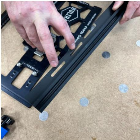
NEHMEN SIE DEN MK3-REPEAT STOP UND POSITIONIEREN SIE DIE LANGEN SCHLITZE MIT DER FLACHEN SEITE DES PROFILS NACH UNTERN.
