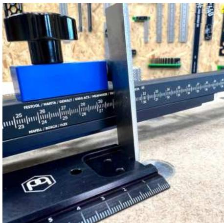
VERWENDEN SIE EIN LINEAL ODER EIN MASSBAND, SCHIEBEN SIE ES UNTER DIE SCHIENE BIS ES AM ANSCHLAG ANSTÖSST
