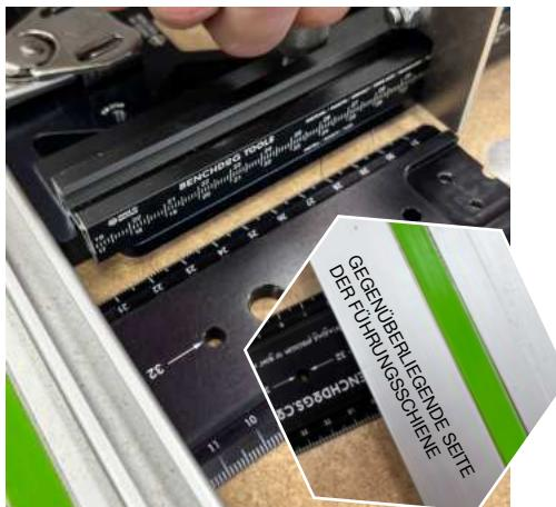
SCHIEBEN SIE DEN ANSCHLAG IN RICHTUNG DER SCHIENE UND ÜBERPRÜFEN SIE, OB DIE MESSUNG MIT DER MESSUNG AUF DEM LINEAL / MASSBAND ÜBEREINSTIMMT.
