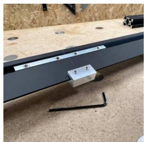
NEHMEN SIE DEN VERBINDUNGSBLOCK UND SCHIEBEN SIE IHN AUF DIE KANTE, WOBEI SIE DARAUF ACHTEN MÜSSEN, DASS ER GENAU IN DER MITTE DER VERBINDUNG SITZT. MIT EINEM 2MM INBUSSCHLÜSSEL KÖNNEN SIE DIE MADENSCHRAUBEN ANZIEHEN UND DER BLOCK IST NUN SICHER BEFESTIGT.
