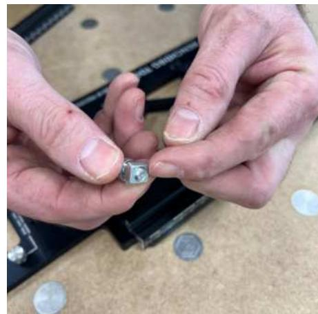
SCHRAUBEN SIE DIE T-NUT-MUTTER BIS ZUR SPITZE DER SCHRAUBE AB.
