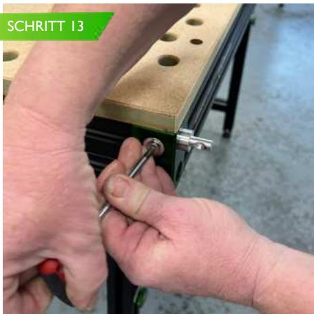
SOBALD DIESE IN POSITION SIND, KÖNNEN SIE SIE MIT EINEM 4 MM INBUSSchlÜSSEL FESTZIEHEN.
