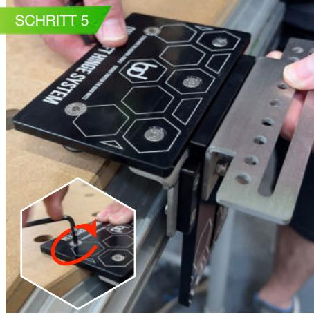
WIEDERHOLEN SIE SCHRITT 3 AUF DER ANDEREN SEITE DES TISCHES, SETZEN SIE DEN GELENKADAPTER EIN UND ZIEHEN SIE IHN WIE IN SCHRITT 4 FEST.
