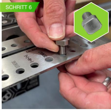
VERWENDEN SIE DIE MITGELIEFERTEN SCHIENENSCHRAUBEN UND STECKEN SIE DIESSE IN DAS GEKENNZEICHNETE LOCH DER FÜHRUNGSSCHIENENMARKE. (FMTE - FESTOOL, MAKITA, TRITON, EVOLUTION)
