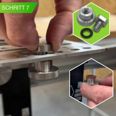
BEFESTIGEN SIE DEN SCHRAUBENBOLZEN MIT EINER M8-UNTERLEGSCHIEBE AN DER RÄNDELSCHRAUBE. VERGEWISSEN SIE SICH, DASS EIN GEWISSES SPIEL VORHANDEN IST, DAMIT DIE SCHIENE EINGESCHOBEN WERDEN KANN.
