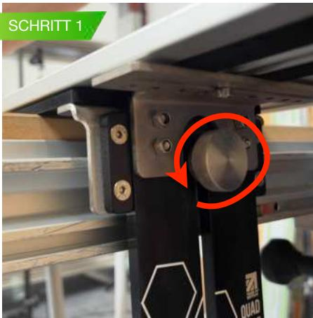
LÖSEN SIE DIE RÄNDELSCHRAUBE AN BEIDEN ENDEN
