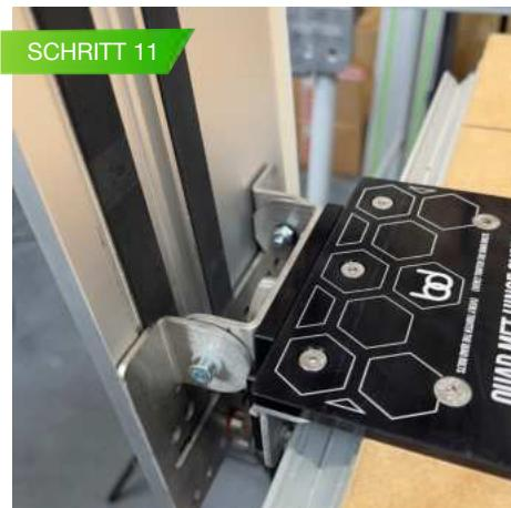
ÜBERPRÜFEN SIE, OB SICH DAS SCHARNIER IN EINE VERTIKALE POSITION HEBT UND IN EINER AUFRECHten ODER ABGESENkEN POSITION BLEIBT. ES WIRD EINE GEWISSE SEITLICHE BEWEGUNG GEBEN, DIES IST NORMAL UND ES WIRD SICH NICHT MEHR BEWEGEN, SOBALD ES IM AUSRICHTUNGSSTIFF SITZT
