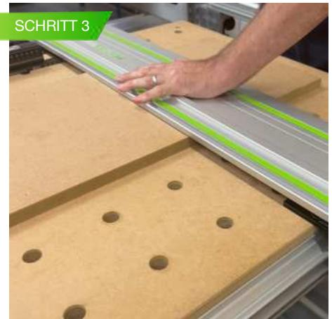
SETZEN SIE DIE SCHIENE WIEDER AB UND LEGEN SIE IHRE HAND UND ÜBEN SIE DRUCK AUF DIE SCHIENE AUS.
