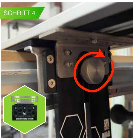
ZIEHEN SIE DIE RÄNDELSCHRAUBEN AN DEM SCHARNIERADAPTER AN.
