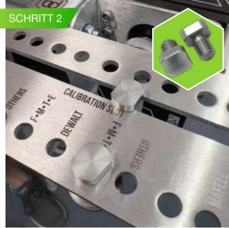
VERSCHIEBEN SIE DIE INNERE FÜHRUNGS-SCHRAUBE UND SETZEN SIE IN DEN KALIBRIERUNGSSCHLITZ UND SCHRAUBEN SIE NICHT FEST.
