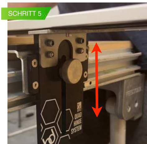
DEN SCHARNIERADAPTER MIT DEM AUSRICHTUNGSSTIFF ANHEBEN.
