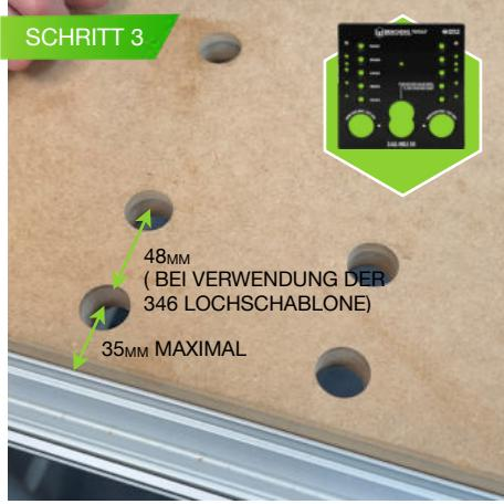
WENN SIE DIE LÖCHER IN IHRER MFT-PLATTE VERWENDEN, STELLEN SIE SICHER, DASS DIE LÖCHER EINEN MAXIMALEN ABSTAND VON 35 MM ZUR TISCHKANTE HABEN. WENN SIE UNSERE 346-VORRICHTUNG VERWENDEN, EMPFEHLEN WIR, DIE LÖCHER IN EINEM ABSTAND VON 48 MM VON EINER LOCHREIHE ZU BOHREN.
