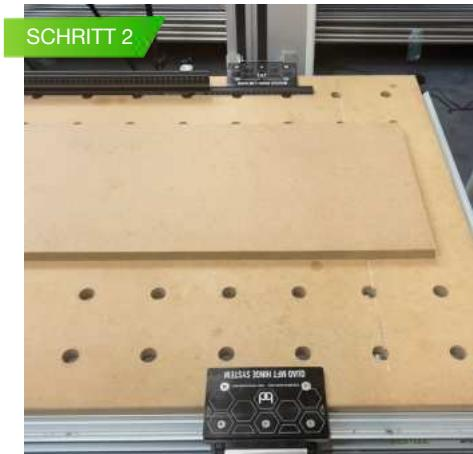
HEBEN SIE DIE SCHIENE AN UND SCHIEBEN SIE DAS ZU SCHNEIDENDE STÜCK MATERIAL UNTER DIE SCHIENE.
