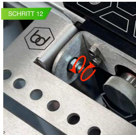
DIE SPANNUNG SO EINSTELLEN, DASS DIE GEWÜNSCHTE SPANNUNG ERREICHT WIRD, DAMIT DIE SCHIENE SICH SELBST HALTEN KANN.
