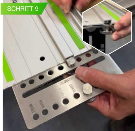
SCHIEBEN SIE DIE SCHIENE IN DIE BOLZEN, RICHTEN SIE DIE KANTE DER SCHIENE MIT DER KANTE DER SCHARNIERPLATTE AUS UND ZIEHEN SIE DIE RÄNDELSCHRAUBEN DER SCHIENENBOLZEN AN, UM DIESE AN DER SCHIENE ZU BEFESTIGEN.
