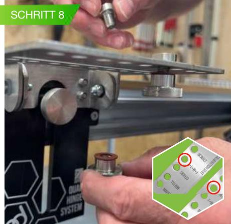
BEFOLGEN SIE DIE GLEICHEN ANWEISUNGEN WIE IN SCHRITT 7 MIT DER ANDEREN M8-UNTERLEGSCHIEBE UND DER INNEREN SCHRAUBE DER SCHIENE. SETZEN SIE DIESE IN EINER LINIE MIT DEM ZUVOR MONTIERTEN SCHIENENBOLZEN EIN.
