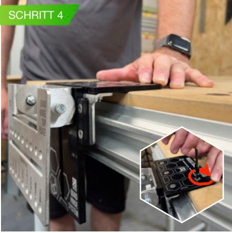
BRINGEN SIE DIE SOCKEL IN POSITION UND SETZEN SIE DEN AUSRICHTUNGSDAPTER IN DIE ERSTEN BEIDEN LÖCHER EIN, DIE IHMEN AM NÄCHSTEN SIND. ZIEHEN SIE DIE SOCKEL MIT DEM 4-MM-INBUSSCHLÜSSEL FEST, BIS SIE SICH NICHT MEHR BEWEGEN.
