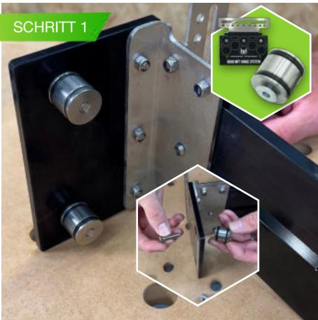
NEHMEN SIE DEN AUSRICHTUNGS-ADAPTER UND DIE GRUNDPLATTEN (2X) MIT DEN ANGEBRACHENEN SCHRAUBEN UND SETZEN SIE IN DIE LÖCHER.
