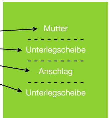
Setzen Sie eine Unterlegscheibe auf den Schraubenbolzen, dann den Anschlag, die verbleibende Unterlegscheibe und schließlich die Mutter.
