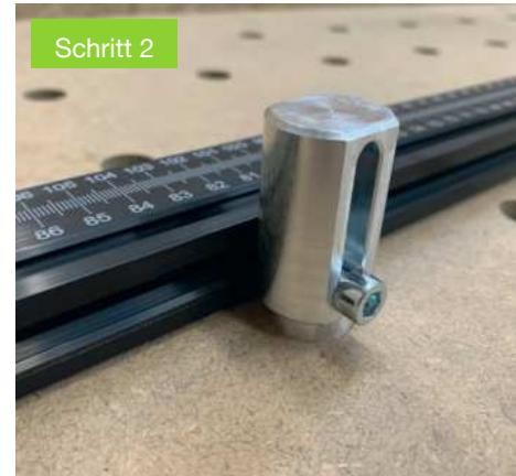
Schieben Sie den Fencedog entlang des Zauns in die gewünschte Position und setzen Sie ihn in das Loch der MFT-Palte ein.
