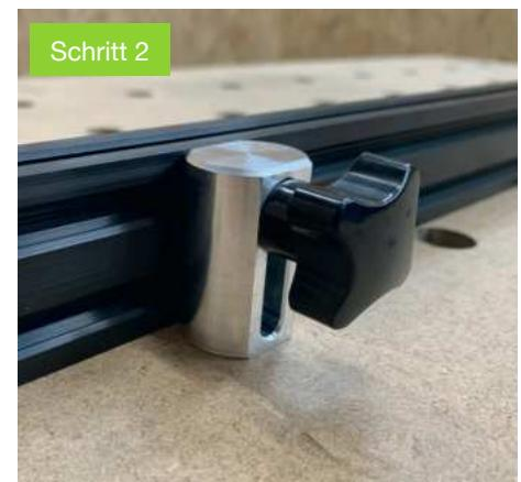
Schieben Sie den Fencedog entlang des Anschlages in die gewünschte Position und setzen Sie ihn in das Loch der MFT-Platte ein.
