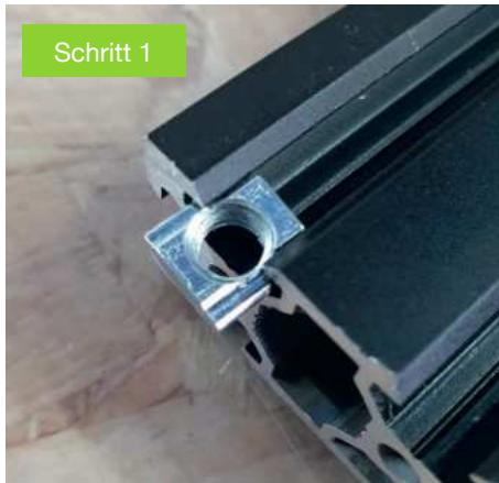
Schieben Sie die T-Nut-Mutter wie oben gezeigt in den Anschlag und schrauben Sie den Fenchdog mit der Rändelschraube in die T-Nut-Mutter.
