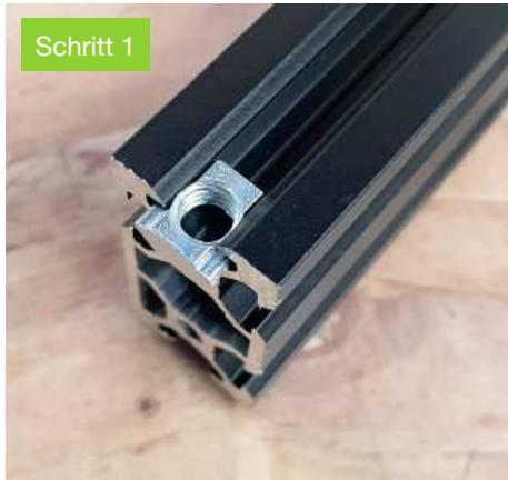
Schieben Sie die T-Nut-Mutter in die schmale Seite des Anschlags, wie oben gezeigt und schrauben Sie den Fencedog mit der Sechskantschraube mit niedrigem Profil in die T-Nut-Mutter.
