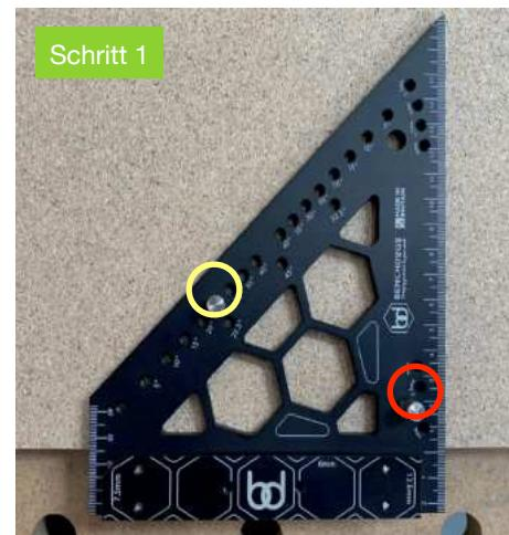
Verwenden Sie die mitgelieferten Passstifte und schrauben Sie den ersten Stift (**ROT**) in das mit „PIVOT“ markierte Loch und den zweiten Stift (**GELB**) in das Loch mit dem gewünschten Winkel.
